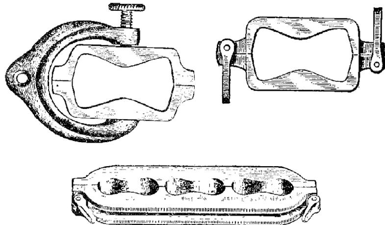
Fig. 17. — Briquette Molds
